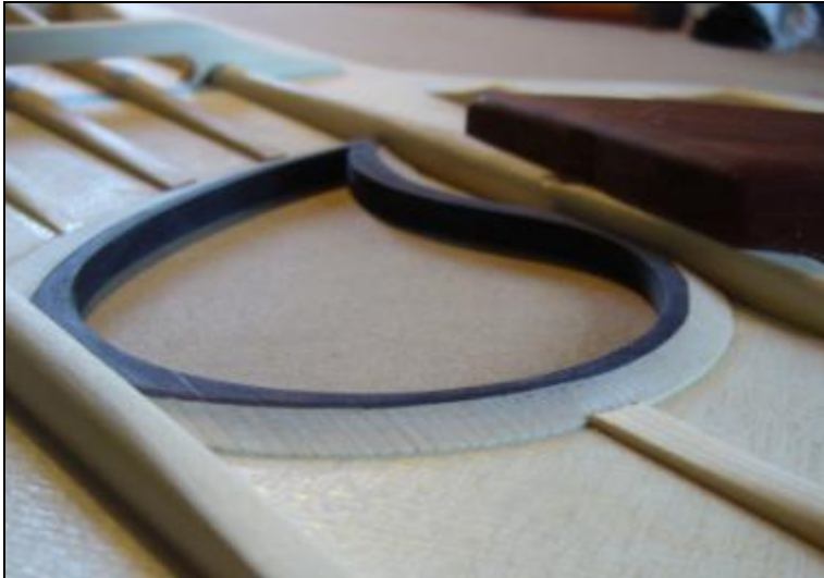
Abbildung 66 Schallochfutter und innerer Schallochrand
