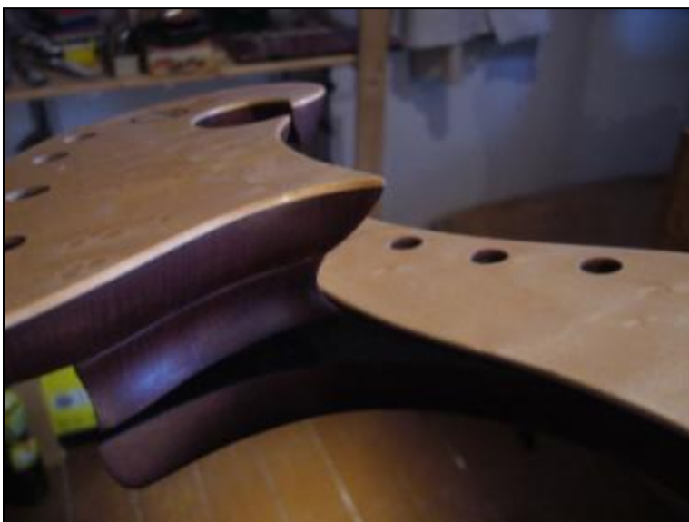
Abbildung 85 Die drei Schichten des Kopfes
