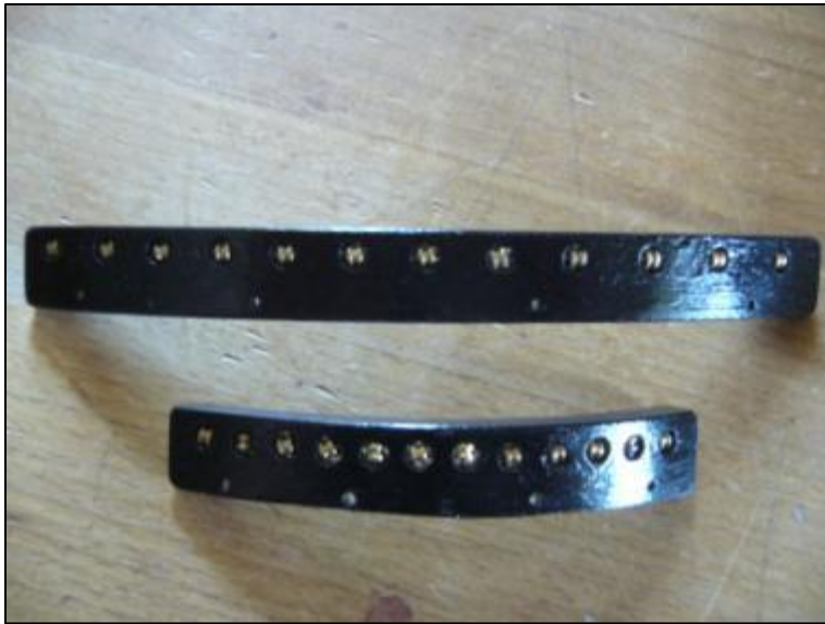
Abbildung 54 Die Prototypen der neu entwickelten Rollensättel
