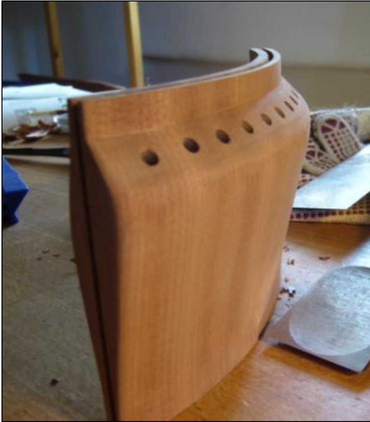
Abbildung 78 Der fertig ausgearbeitete Wirbelstock
