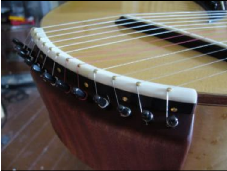
Abbildung 91 Zithermechaniken und unterer Resonanzsaiten-Sattel
