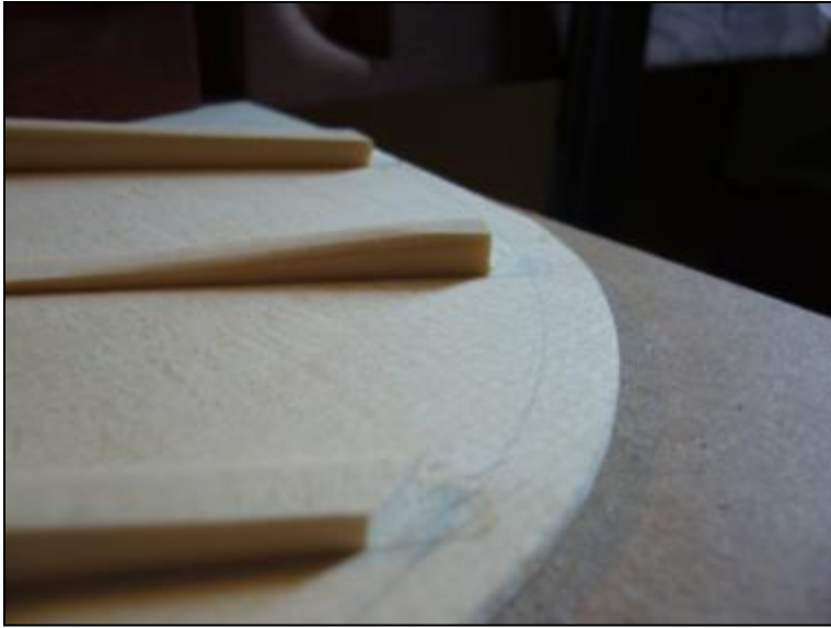
Abbildung 64 Leistenenden stützen Wirbelstock und Saitenhalter
