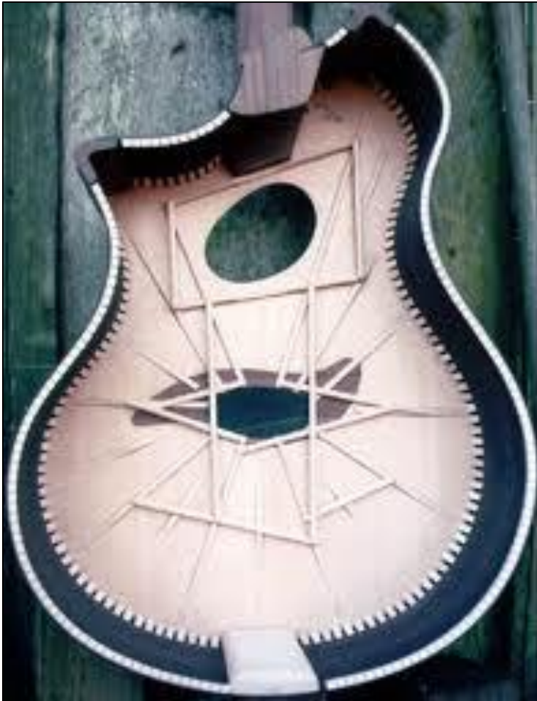
Abbildung 27 Die Deckenbeleistung einer Sympitar
