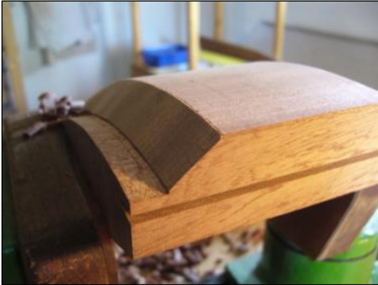
Abbildung 76 Ein gegliederter Arbeitsablauf zur Herstellung des Wirbelstocks ermöglichte den Einsatz von Maschinen
