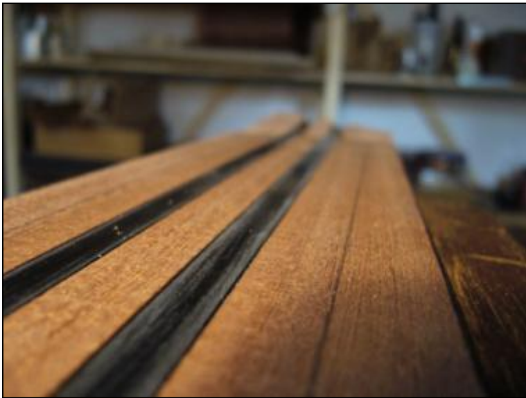
Abbildung 81 Karbonstäbe zur Erhöhung der Längssteifigkeit
