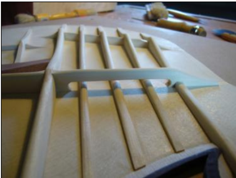
Abbildung 63 Weit ausgefederte Leisten unter dem Resonanzsaitensteg
