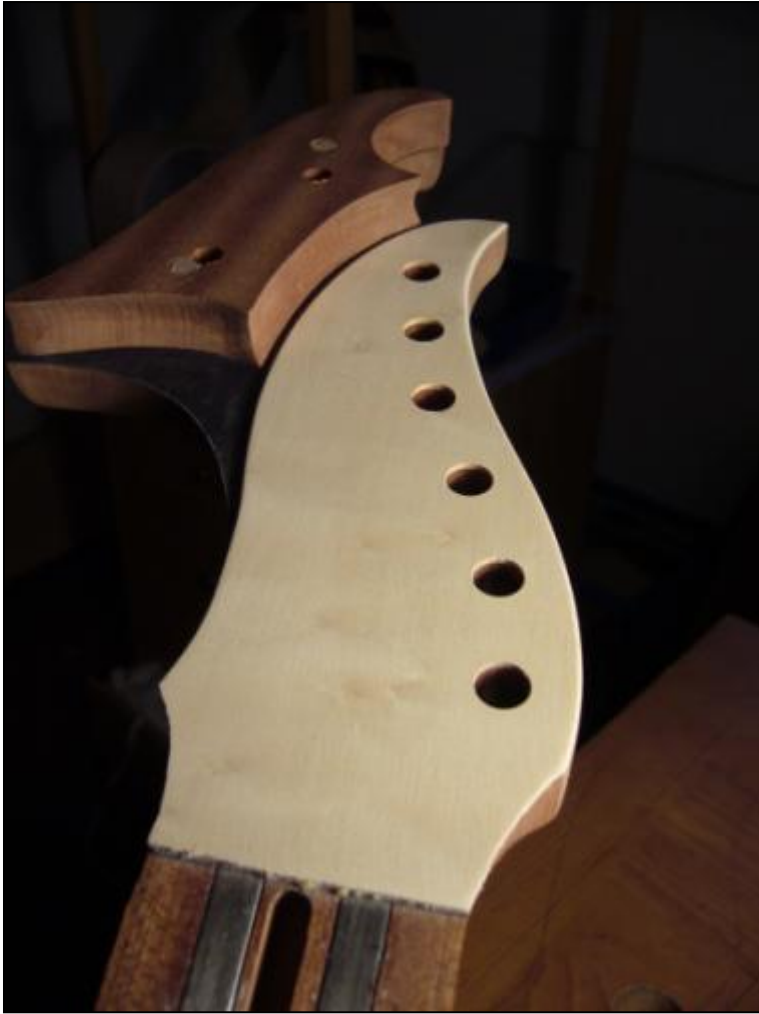
Abbildung 84 Das Distanzstück zum oberen Kopf ist aufgeleimt
