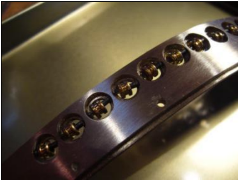
Abbildung 88 Die Rollen lagern auf ihren Achsen in der dritten Schicht
