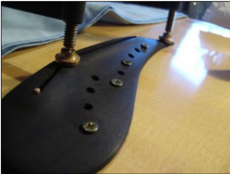
Abbildung 96 Aufleimen des Hauptstegs mittels zusätzlicher Druckwirkung durch Schrauben
