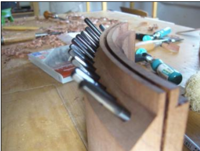
Abbildung 77 Nuten an den Stirnenden nehmen die Korpusränder auf
