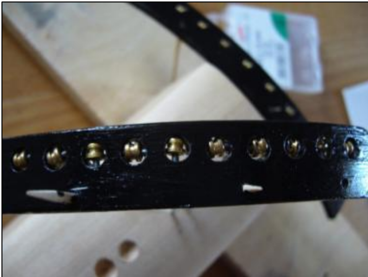
Abbildung 89 Fertiger Rollensattel während des Lackierens
