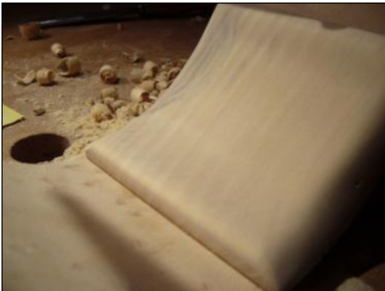
Abbildung 80 Der Klotz wurde flächig an die Zarge geleimt
