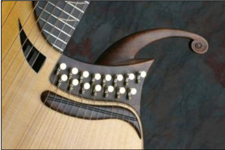
Abbildung 33 Violinen-Feinstimmer für das Feintuning der zusätzlichen Diskantsaiten (Harfensaiten / Resonanzsaiten)
