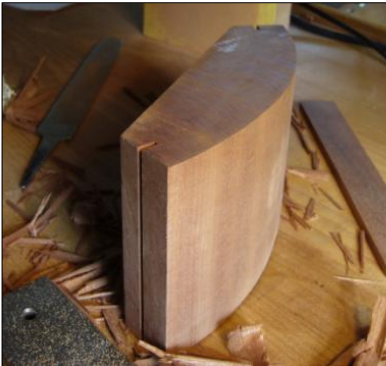
Abbildung 75 Die Nuten dienen der Aufnahme der Zargenenden
