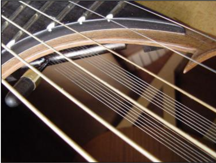
Abbildung 28 Dämpfungsmechanismus für Resonanzsaiten
