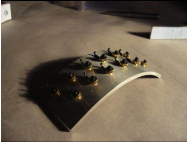
Abbildung 92 Unlackierter Saitenhalter mit Feinstimmern
