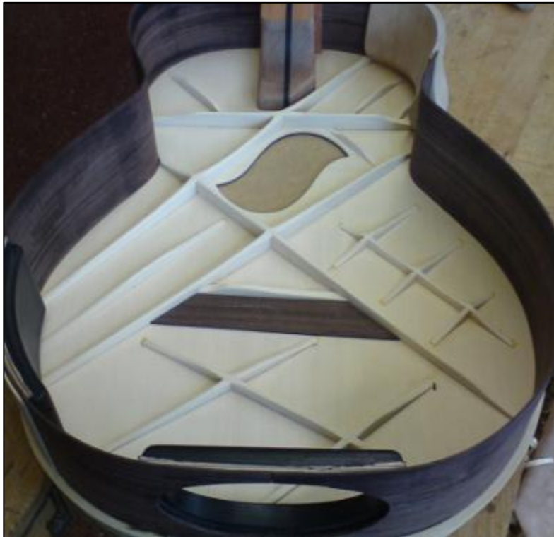
Abbildung 53 Deckenbeleistung der ersten Aliquot-Gitarre
