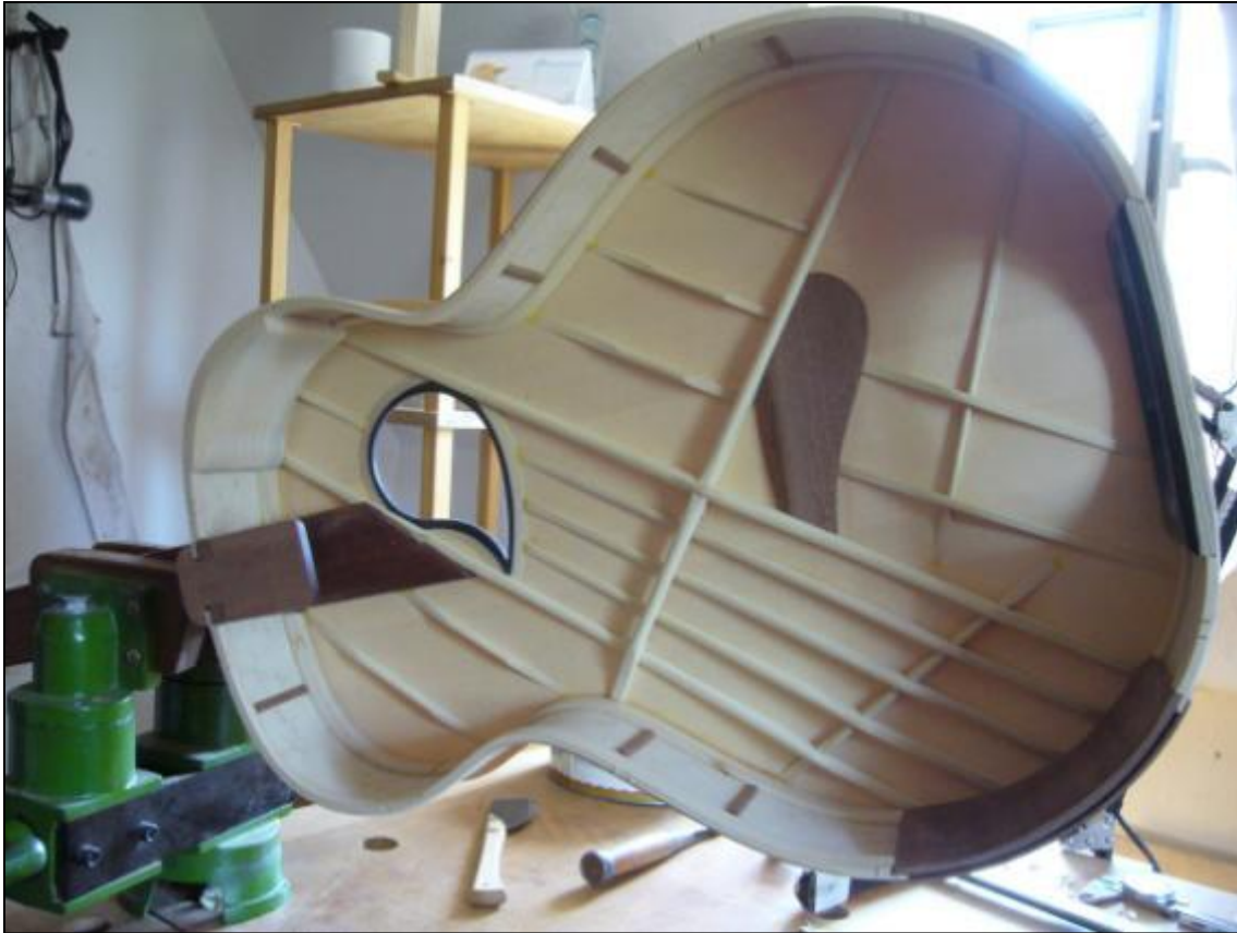
Abbildung 58 Fertig ausgearbeitete Deckenbeleistung
