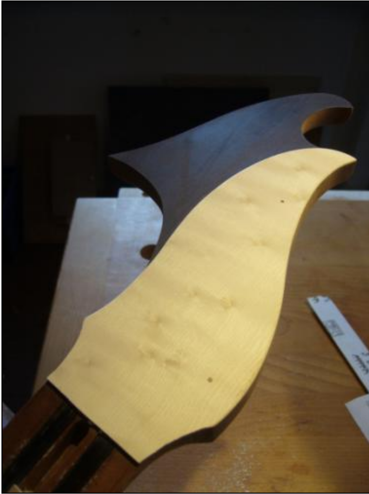
Abbildung 83 Furnierter unterer Kopf
